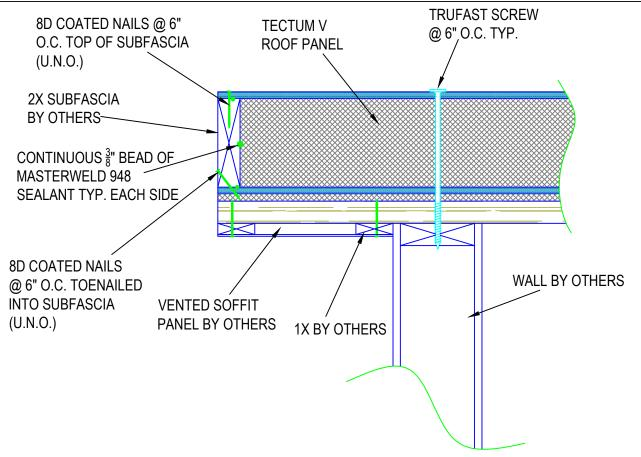
NOTE: OVERHANG DETAIL FOR TECTUM COMPOSITE PANELS. MAXIMUM OVERHANG FOR 5" OR THICKER PANELS IS 24". THE OVERHANG IS ALSO LIMITED TO 1/3 OF THE PANEL LENGTH OR WIDTH EXTENDING OVER THE WALL TO THE INSIDE. MAXIMUM OVERHANG ALONG PANEL WIDTH IS 16" WHEN A FULL WIDTH PANEL IS AT THE EDGE.
